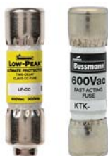
Fig 5. Säkringen till vänster är nycklad - rejection type klass CC, säkringen till höger är en Midget säkring. Båda säkringarna har samma dimensioner, 10,3x38,1 mm. En av kontakthylsorna på klass CC säkringen är försedd med en nyckling, i detta fallet en tapp. Konstruktionen förhindrar att en Midget säkring kan installeras i en säkringshållare avsedd för klass CC säkringar.
